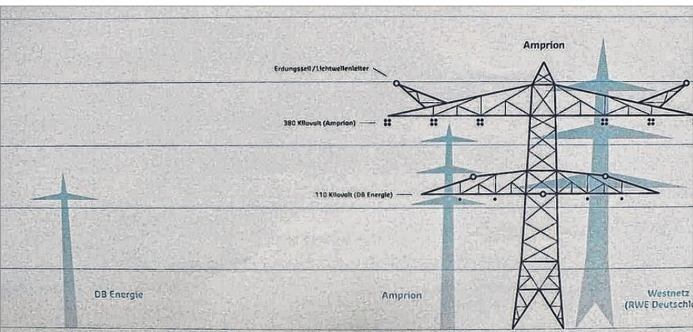
Auf dieser Skizze wird deutlich, wie sich das Talprofil von Apollmicke künftig darstellen wird. Die hellblauen Masten entfallen, sie werden durch den skizzierten Gittermasten und ein Erdkabel ersetzt.
